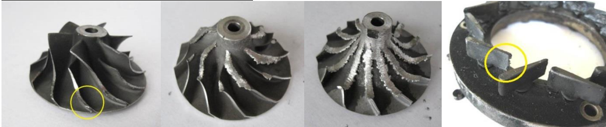
Contamination de l'huile ou mauvaise lubrification
