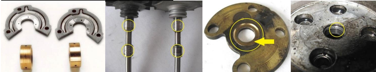
Cokéfaction d'huile : Coupure moteur immédiate après l'utilisation intensive et prolongée du turbo
