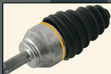
**Pour faciliter le montage, vous pouvez utiliser nos cônes de montage K2804 (Ø78mm), K2800 (Ø88mm) et K2805 (Ø100mm) ou notre pince pneumatique K2410.**
